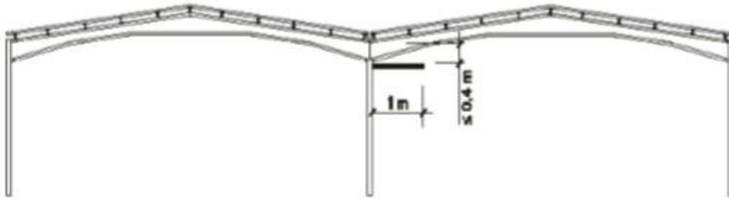
En nuestro caso, en la medianera con las edificaciones se colocará una barrera colocada a una distancia inferior a 40 cm de la cubierta y con una EI60 en donde la altura del panel de fachada sea inferior a 1,00 m, tal y como se detalla en plano Secciones y plano Instalación de Protección Contra Incendios
